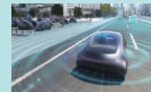
電波を受信し、得られる信号から周囲のターゲットの位置や速度を算出。前方だけでなく、斜め後ろの死角検知にも役立ちます
